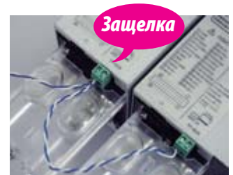
Шина TP-BUS использует гирляндное соединение. Это упрощает добавление источников питания и аккуратно соединяет кабели.
